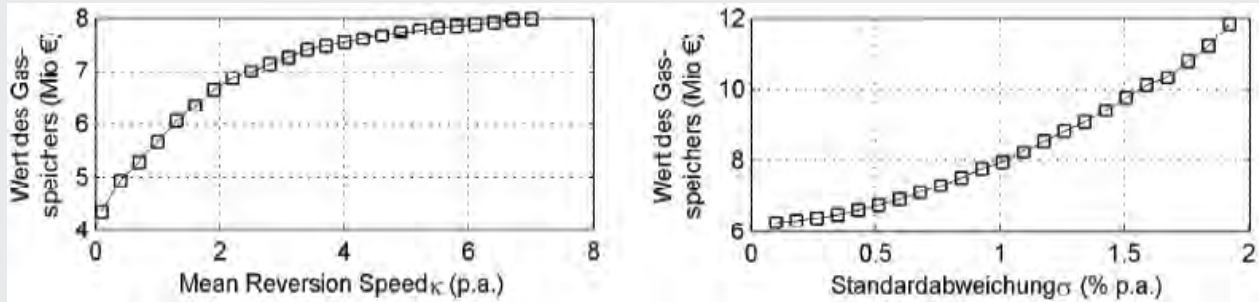
Abb. 14 | Sensitivität des Speicherwertes von Parametervariationen der Prozesskomponenten
